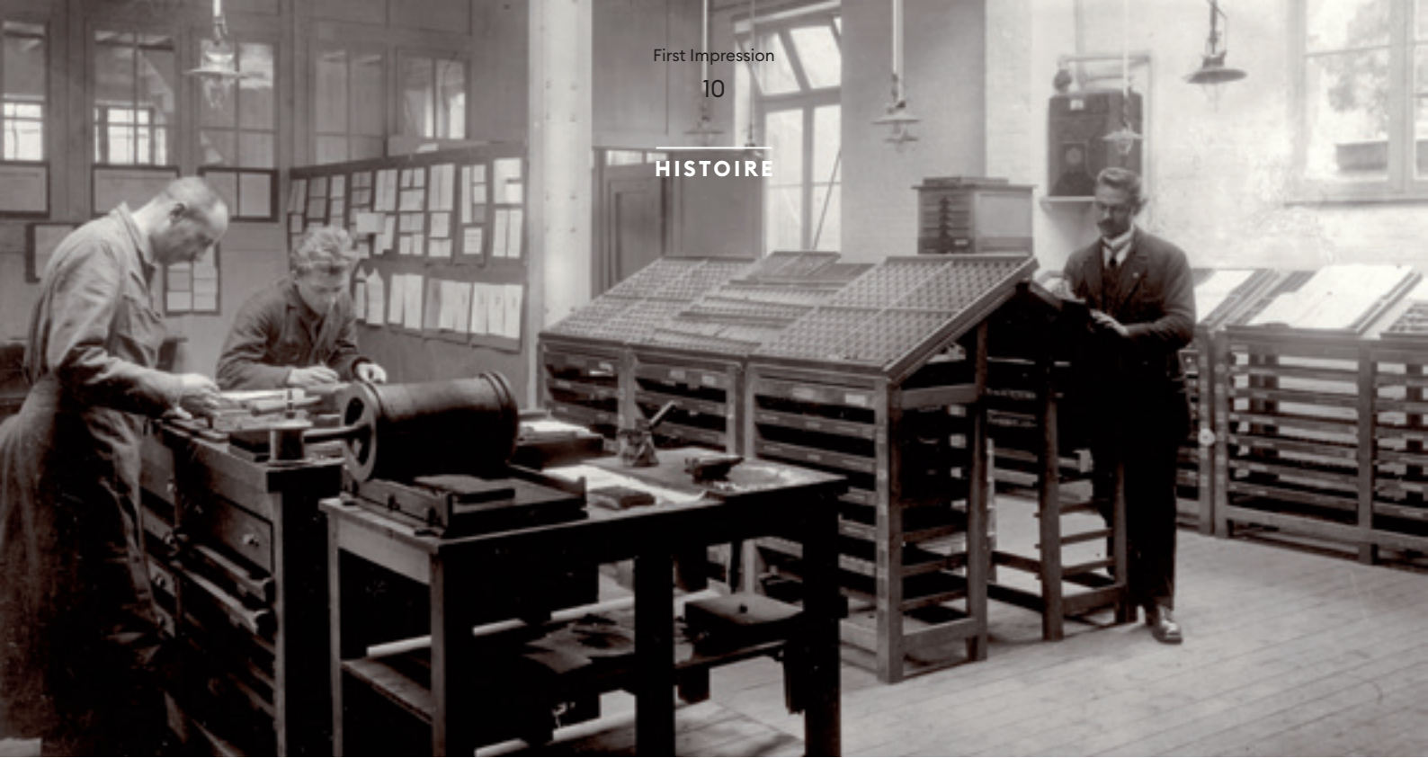
● Vue intérieure de la salle de travaux pratiques du cours de formation graphique à la Vrije Beroepsschool (aujourd'hui VTI) à Bruges, avec des bancs de composition et compartiments à caractères pour la composition manuelle, des tables de travail et une presse à épreuves. Collection du Musée de l'Industrie.
